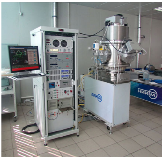
Рис. 2. Полупромышленная установка для напыления тонких пленок с ионным стимулированием
