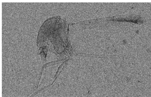
Фазово-контрастное изображение комара, полученное на лазерно-плазменном рентгеновском источнике
